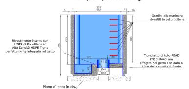
En étroite collaboration avec le bureau d'études de Vermillion, **Coprem** a conçu un puisard intégralement recouvert du liner HDPE facilement manutentionable et un débourbeur séparateur hydrocarbures.
